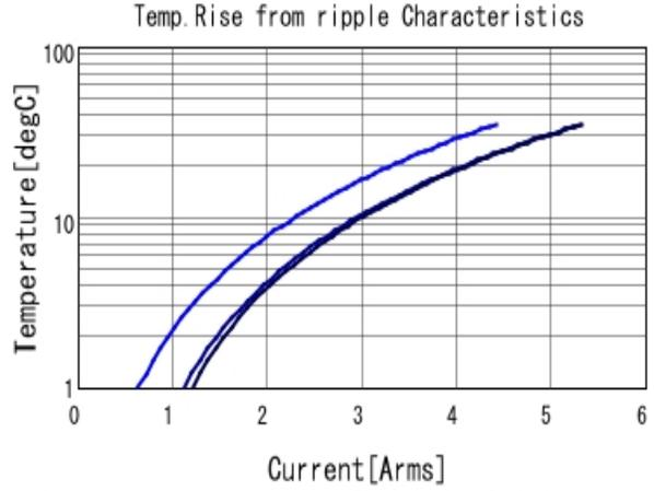
■ GRT188R61A226ME13 Temp. rise ■ 80kHz ■ 400kHz ■ 800kHz
