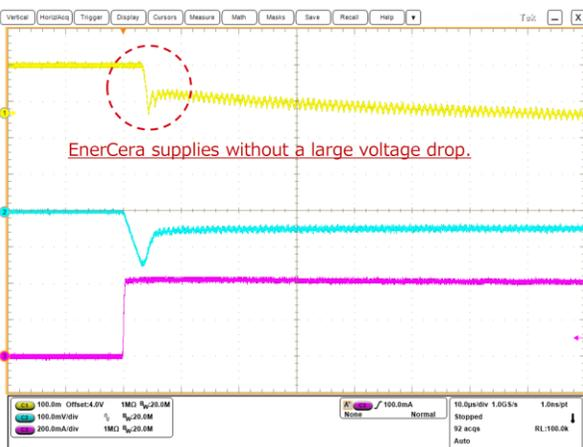
\*Slew rate :  $t_r=t_f=1\mu\text{sec}$
